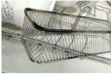
被锈蚀的消毒柜内部。
